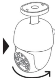
カメラを矢印の方向に90度回転させます
