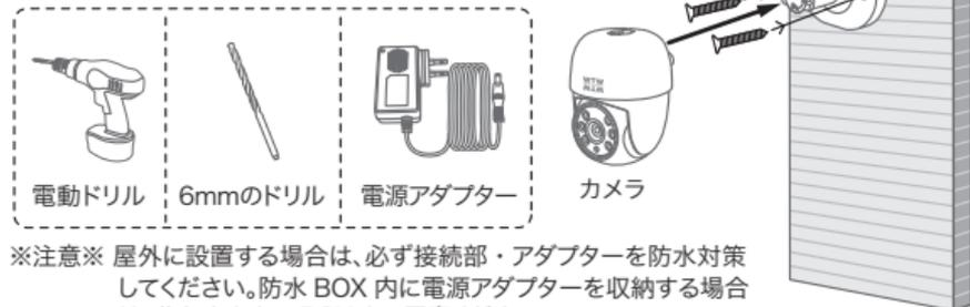
※注意※ 屋外に設置する場合は、必ず接続部・アダプターを防水対策してください。防水BOX内に電源アダプターを収納する場合は、分な大きさのBOXをご用意ください。
