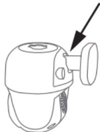
壁面に設置するときは本体背面の取付部に基台を取り付けてください
