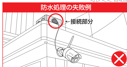
↑接続部分がカメラより上だと水が入る可能性があります。
