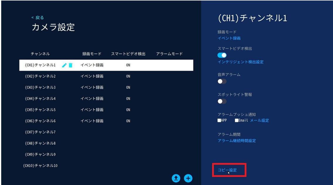
②画面左端にチェックボックスが出るのでコピーを反映させたい CH にチェックを入れ適用を左クリックします。
