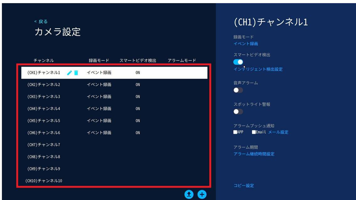
④「音声アラーム」「スポットライト警報」から必要な項目を ON にして、アラーム継続期間設定を左クリックします。
