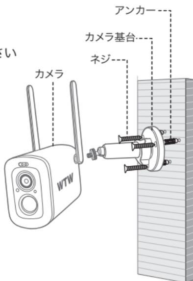
※基台のカバーを回転させて外し、ベース部分を壁面に固定してからカバー部分をベースに取り付けます
