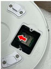
①マイクロSDカードスロットの蓋を取り外し、カード押さえ金具を矢印の方向にスライドさせる
