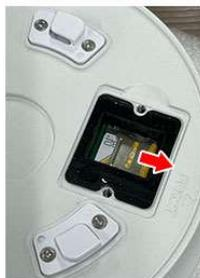
④カード押さえ金具を倒し、矢印の方向にスライドさせてカードを固定する
