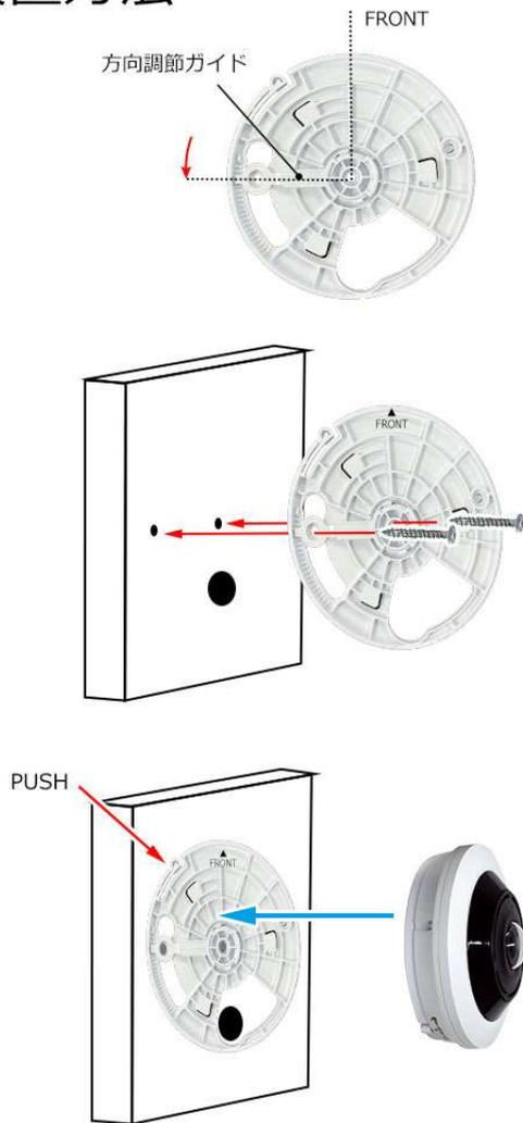
①設置用プレートの方向調節ガイドを中心軸を中心に回転させ、FRONT方向と90度になるようにしてください。
