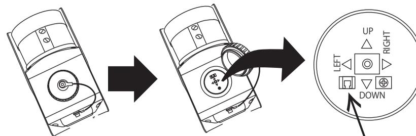
SETUPジョイスティックを押すと、メニューが表示されます。メニュー表示中のジョイスティックの動作は下記の通りです。
