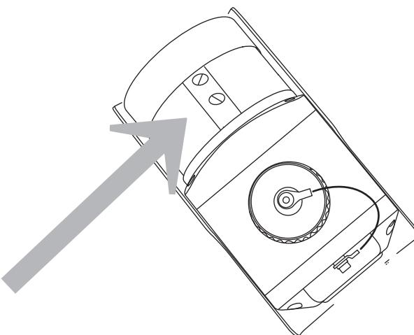
本体底面に、調整ネジがついておりますので、マイナスドライバーなどで調整を行って下さい。
