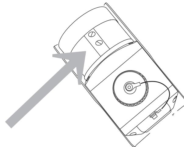
本体底面に、調整ネジがついておりますので、マイナスドライバーなどで調整を行って下さい。
