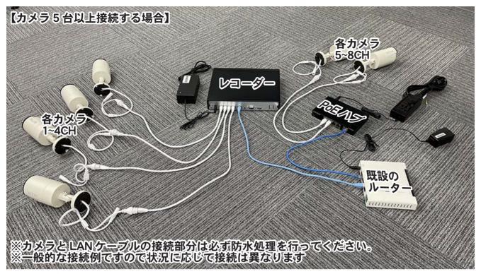
上記の写真のように接続してください。 カメラ 1~4CH は、レコーダー本体に直接接続し、5 台目以降は PoE ハブに接続し、 既設のルーターに接続を行ってください。上記写真の PoE ハブは NETGEAR GS305P を使用した場合の接続例となっております。
