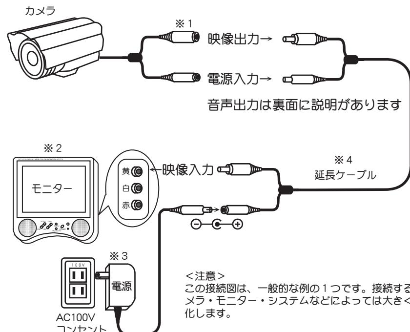
※1：カメラの映像出力コネクターには、下図の様な形状のものもあります。図1はそのまま接続図のように接続が可能ですが、図2・3は、変換コネクターを使用して下さい。
