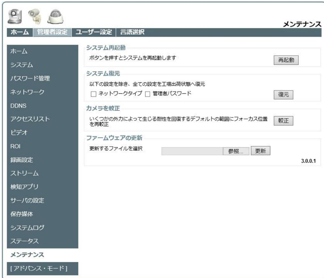
システム再起動：IPカメラを再起動します
