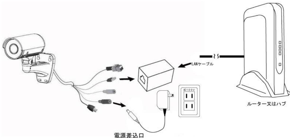
IPカメラに電源とLANケーブルを接続して下さい
