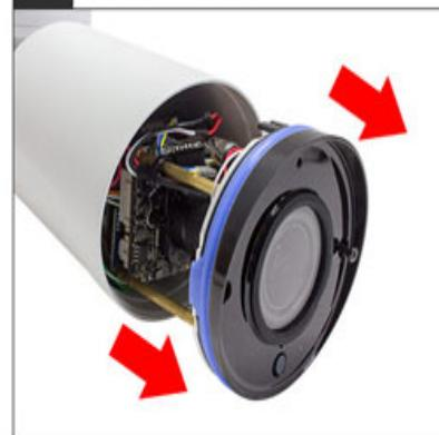
前面のカバーを引っ張り、中の基盤を引き出します。
