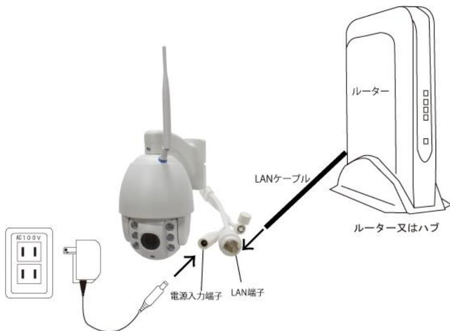
IPカメラに電源とLANケーブルを接続して下さい
