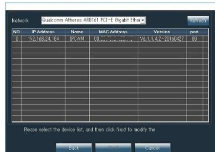
IPアドレスを変更したい場合は上段のIP、SubMask、GateWayに値を入力し[Next]を押して下さい
