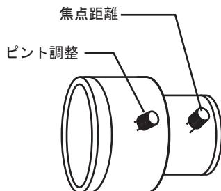
カメラのカバーを外すと、左図のレンズがむき出します。レンズについているトリマーを緩めてから調整を行って下さい
