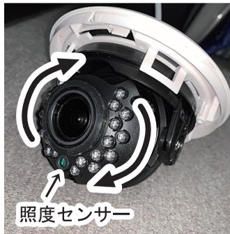
左図の様に、照度センサーが下方向になるようにカメラユニットは回転しますので、設置する角度によって調整を行ってください。
