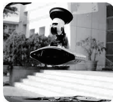
③ カメラを設置します。この時、カチッと音が鳴り、ロックがかかっていることを確認してください
