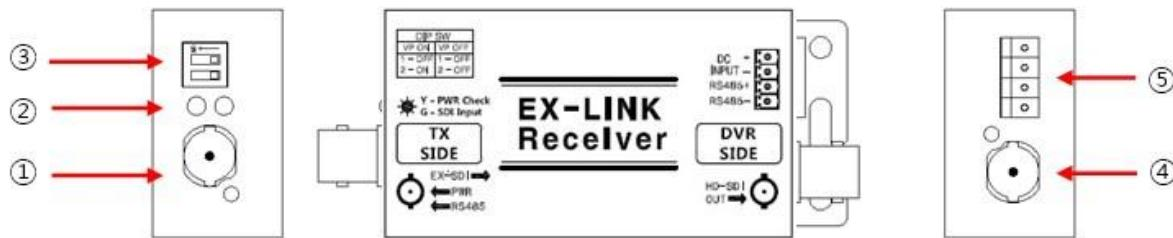
① **EX-SDI IN:** 送信機(WTW-LHTP0801D), 中継器(HLR01P), カメラ(HD-SDI出力) 等と同じ HD-SDI出力装置の信号を受信します。
