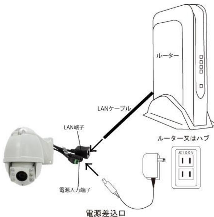
IPカメラに電源とLANケーブルを接続して下さい
