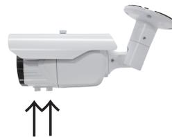
本体底面に、調整ネジがついておりますので、調整を行って下さい。
