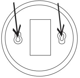
※天井のボードにネジがしっかりと固定されない場合は 付属されております、プラスチックアンカー(緑)を 先に埋め込んでいただき、そこに対してネジ固定してください
