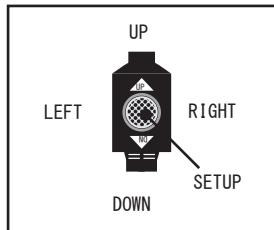
SETUP ジョイスティックを押すと、メニューが表示されます。メニュー表示中のジョイスティックの動作は下記の通りです。
