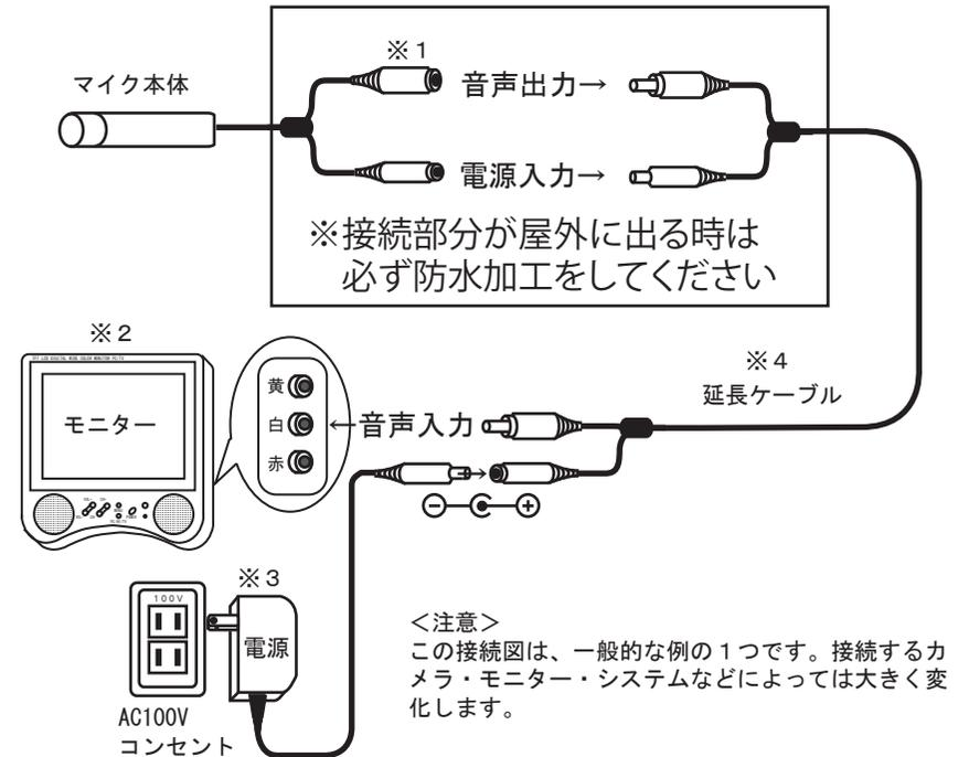
※1: マイクの音声出力コネクターには、下図の様な形状のものもあります。図1はそのまま接続図のように接続が可能です。図2・3は、変換コネクターを使用して下さい。
