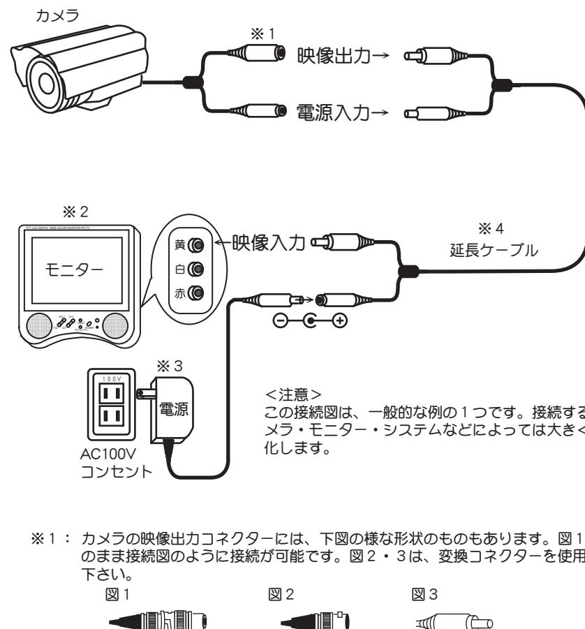
※ 1 : カメラの映像出力コネクターには、下図の様な形状のものもあります。図1はそのまま接続図のように接続が可能ですが、図2・3は、変換コネクターを使用して下さい。
