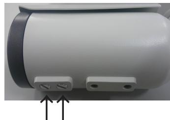
本体底面に、調整ネジがついておりますので、マイナスドライバーなどで調整を行って下さい。
