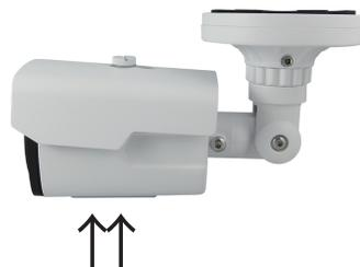
本体底面に、調整ネジがついておりますので、調整を行って下さい。
