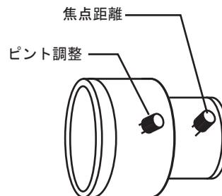
カメラのカバーを外すと、左図のレンズがむき出しになります。レンズについているトリマーを緩めてから調整を行って下さい
