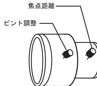
カメラのカバーを外すと、左図のレンズがむき出します。レンズについているトリマーを緩めてから調整を行って下さい
