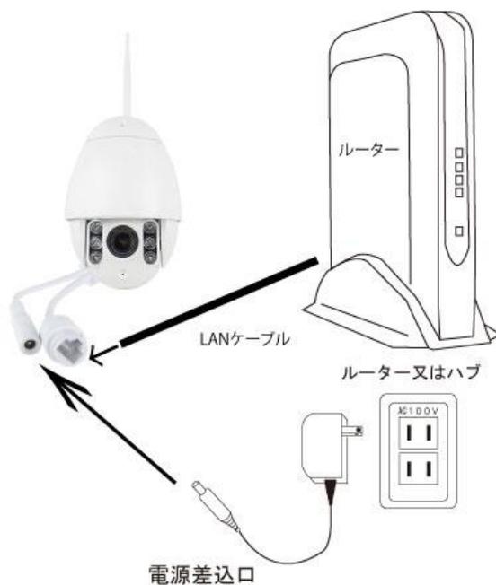
IPカメラに付属の電源とLANケーブルを接続して下さい
