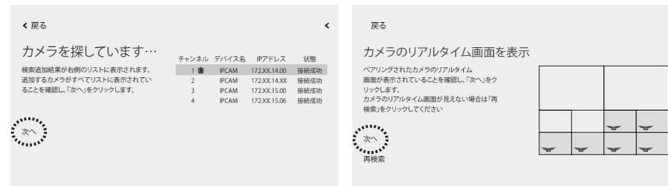
④ 【カメラ設定】画面にて接続されたカメラが一覧表示されます。【戻る】→【戻る】を左クリックでメイン画面へ戻ります。(登録されたカメラの映像が表示されます)
