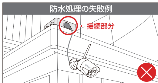
↑接続部分がカメラより上だと水が入る可能性があります。
