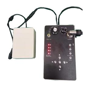
コントローラーにSDカードを 入れてください(最大32GB) 8GBのSDカードが挿入されています 交換する場合はFAT32対応のSDカー ドを使用してください(32GBまで)
