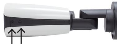
本体底面に、調整ネジがついておりますので、調整を行って下さい。
