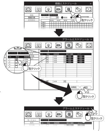
●ライブ映像画面に戻り、指定したカメラチャンネルに 黄色のカセットテープアイコンが表示されていれば、 モーション録画の設定完了です。
