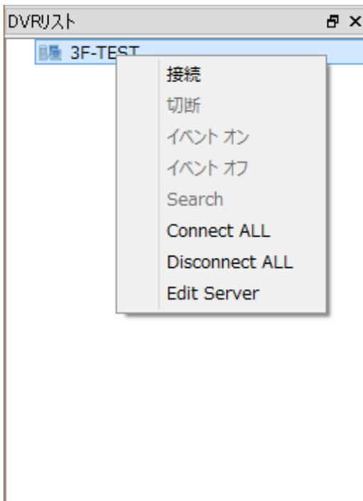
Setup - Server Setupで設定されたDVRにアクセスすることができます。追加されたDVRをマウスの右クリック時のメニューが表示されず。
