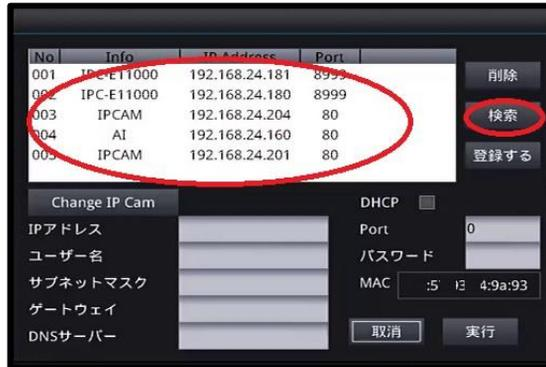
[検索]ボタンを押すと同一ネットワーク内のIPカメラを検索しリストが表示されます
