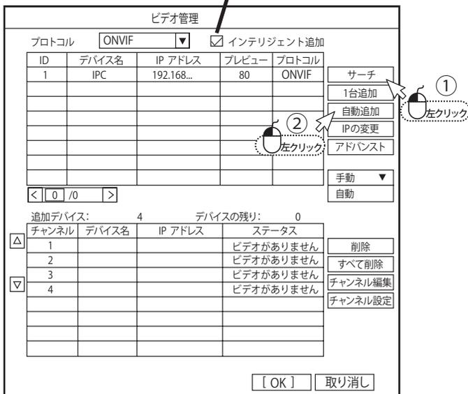
③「ONVIF」に変更したら【サーチ】を<sup>①</sup>左クリックしますと、LANケーブルで繋がっているカメラの情報が上段に表示されます。表示されたら【自動追加】を<sup>②</sup>左クリックします。下記のご案内が表示されるので「はい」を選択します。
