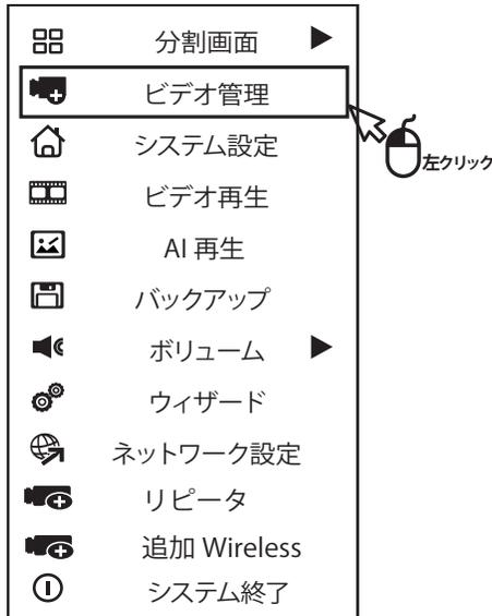
②ビデオ管理画面が表示されるので、画面の上部の「プロトコル」を<sup>①</sup>左クリックして、「ONVIF」に変更します。
