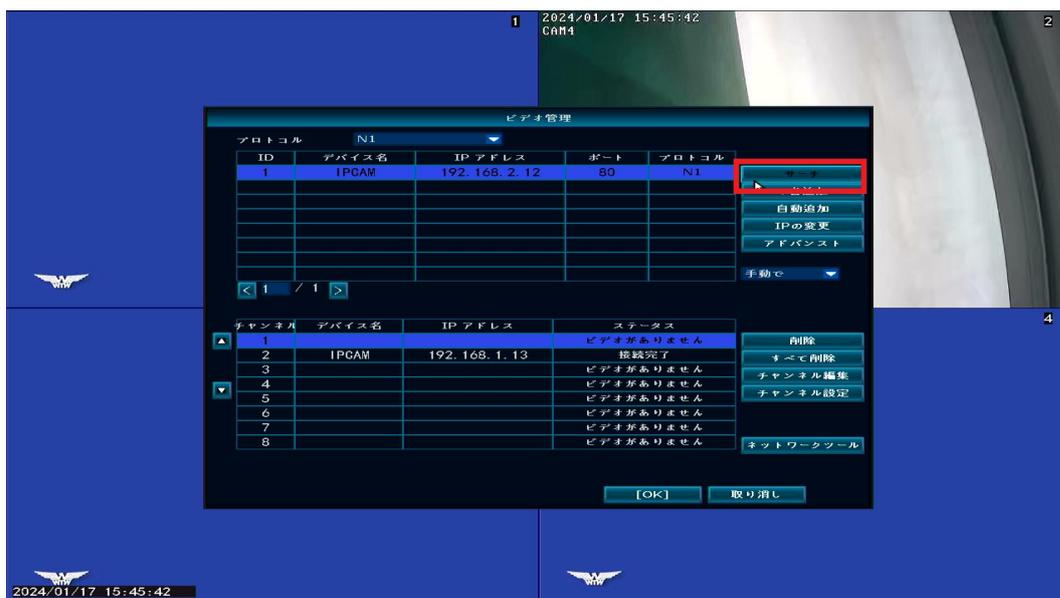
④上の表に表示されたカメラ情報を左クリックしてから「IPの変更」を左クリックします。
