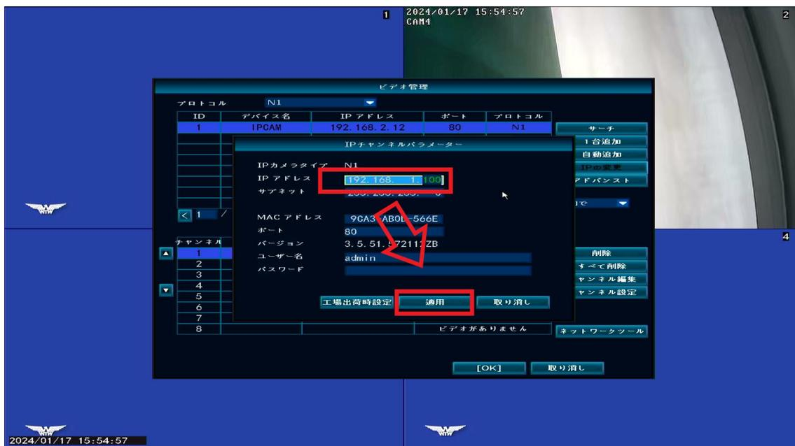
⑤「セットアップに成功しました」と表示されたら設定完了です。確認後、取り消しを左クリックして下さい。
